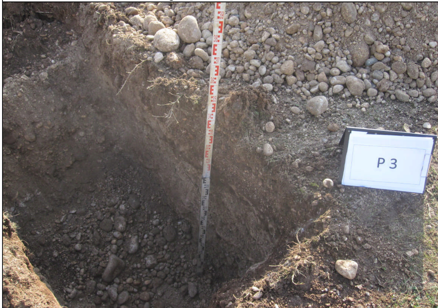
Vista d'insieme della sezione stratigrafica relativa alla trincea esplorativa n.3 e litologia rinvenuta durante lo scavo
