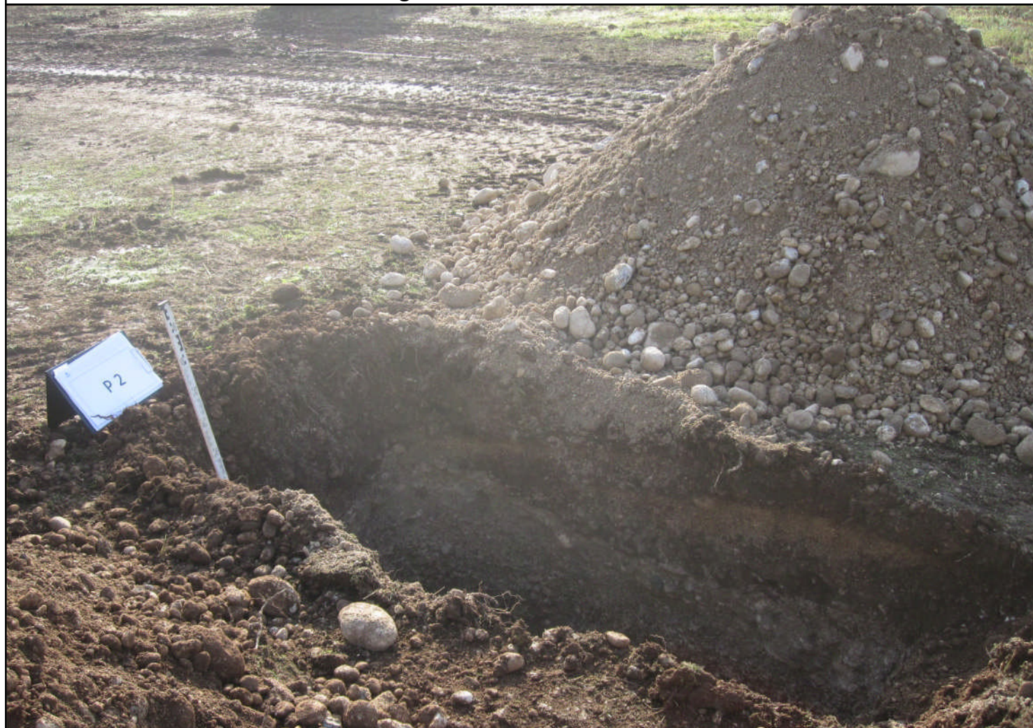
Vista d'insieme della sezione stratigrafica relativa alla trincea esplorativa n.2 e litologia rinvenuta durante lo scavo
